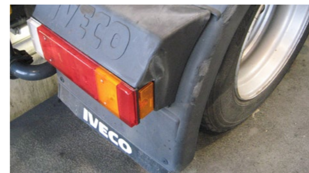
Zgârieturi adânci și deformare
