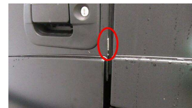
Fisură pe marginea ușii
