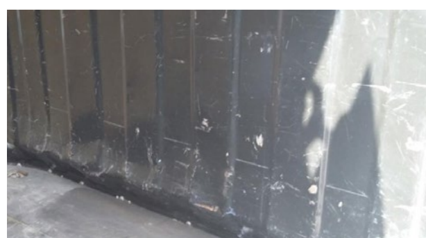
Deformări interne: Deformare ușoară fără perforări sau tăieturi, durată de reparare \leq 3 h
